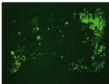
Eksempel på billedanalyse af tilsmudset overflade med smuds tilsat fluorescens før (venstre) og efter (højre) rengøring i et CIP-system. Kontrasten gør det nemt at kvantificere andelen af tilbageværende smuds.
